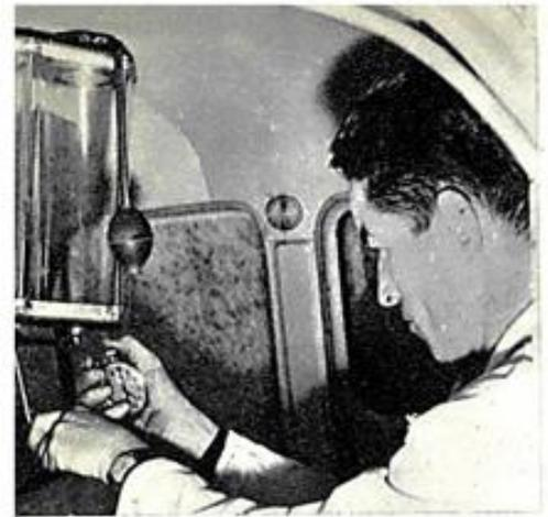
Mise en fonctionnement du circuit d'alimentation et chronométrage sur base élargie lors des essais de reprise.
